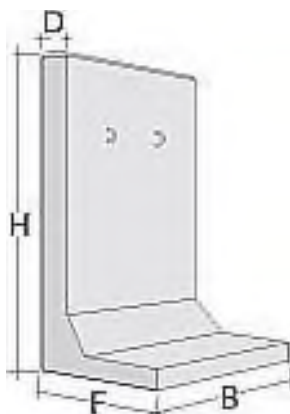
Rys. 1. Przykład żelbetowego wspornika kątego do wykonywania murów oporowych
