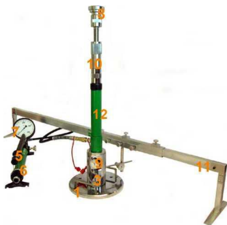
Rys. 1.2. Aparatura VSS z jednopunktowym pomiarem przemieszczenia płyty
