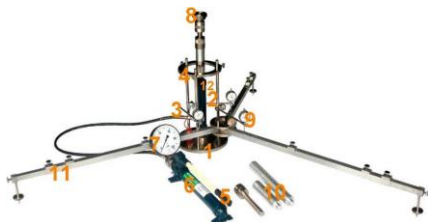
Rys. 1.1. Aparatura VSS z trzypunktowym pomiarem przemieszczenia płyty
