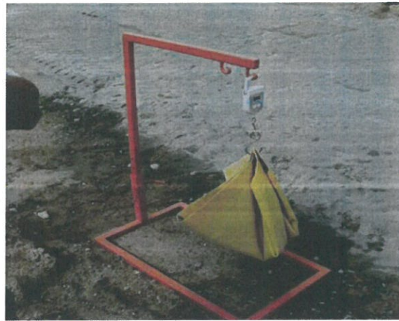
Ważenie tacki pomiarowej ze spoiwem
