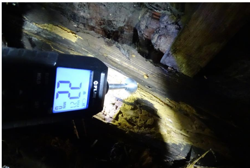
Fot. 50 Pomiar na elemencie drewnianym dachu od strony wschodniej: 22%
