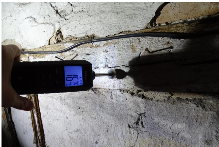
Fot. 49 Pomiar wilgotności kolejnego elementu drewnianego: 16%
