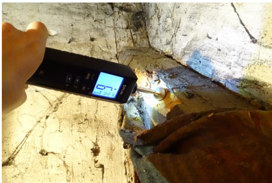
Fot. 48 Pomiar wilgotności drewnianego słupa: 6%
