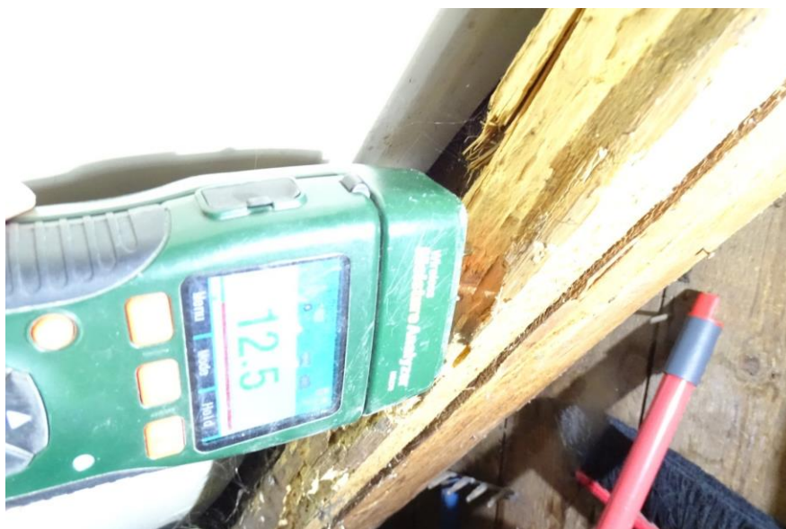
Fot. 45 Pomiar wilgotności drewna (krokiew zach.) : 12,5%
