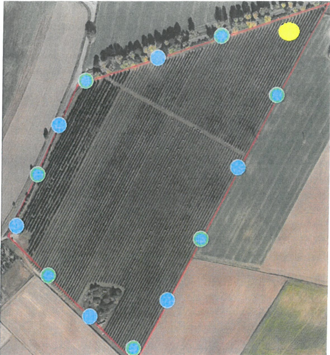
Rys. 3. Rozmieszczenie punktów oświetleniowo dozorowych. Kolorem błękitnym oznaczono umiejscowienie słupów. Na każdym słupie zawarte są 2 kamery stałopozycyjne. Kolorem żółtym oznaczono umiejscowienie słupa przy stróżówce. Wszystkie szczegóły techniczne pkt 1.3. – Warunki techniczne
