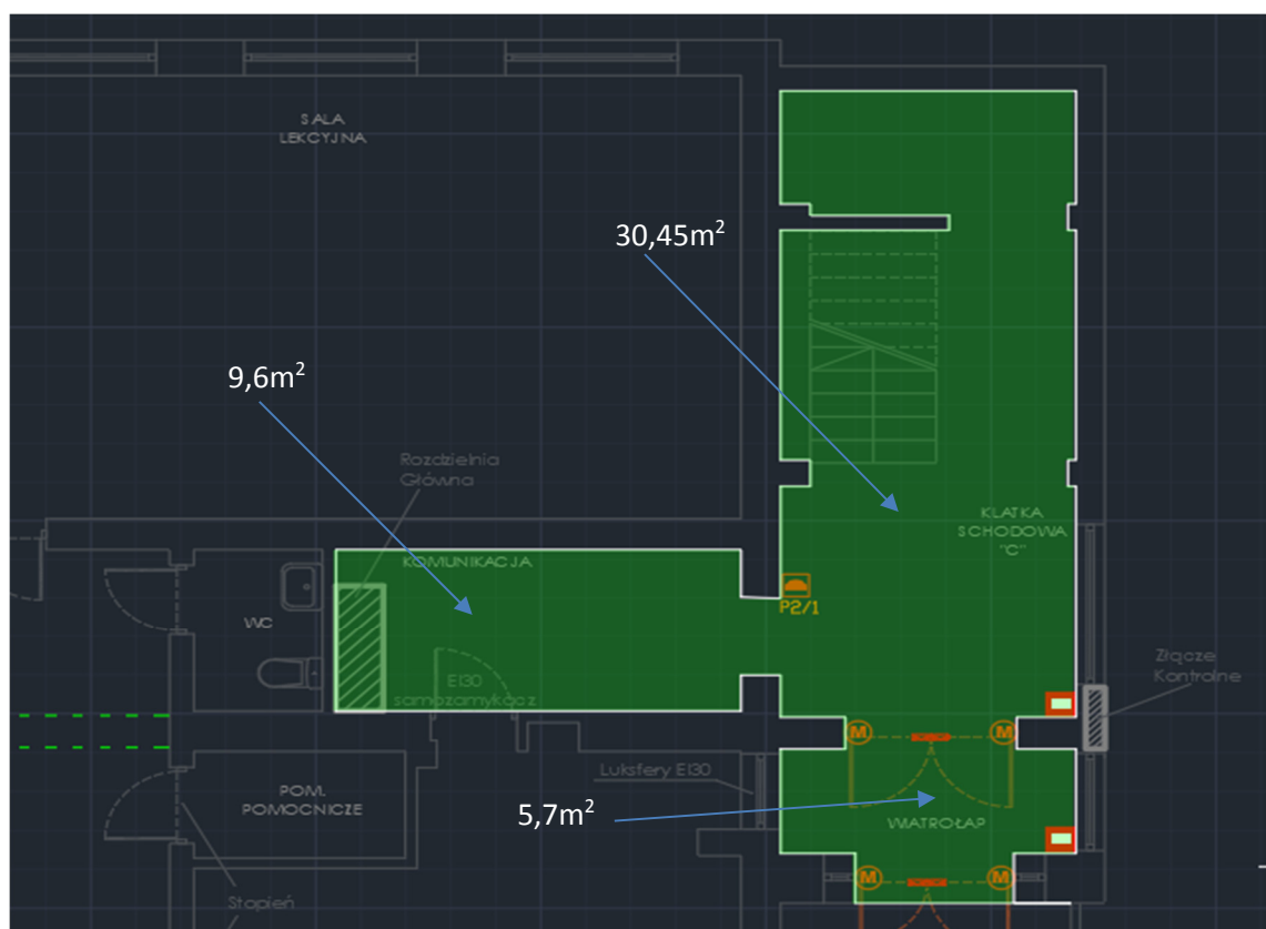
Rysunek 2: Wyznaczenie największej powierzchni rzutu poziomego klatki schodowej „C”
