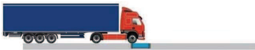
Rys. 3. Wymagane ułożenie wag podczas ważenia pojazdu (wszystkie koła na tej samej wysokości).
