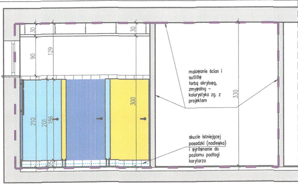
PRZEKRÓJ A - A - 1 i 2 PIĘTRO
