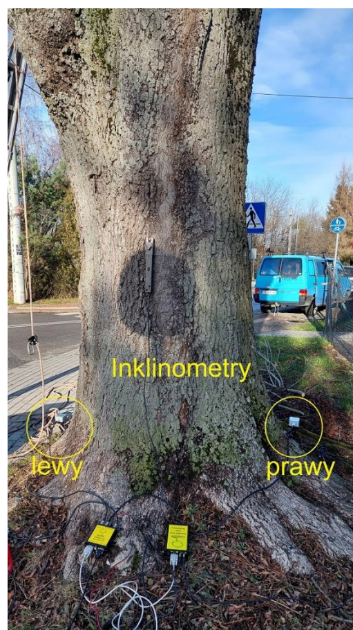
Fot. 03 – Rozmieszczenie inklinometrów
