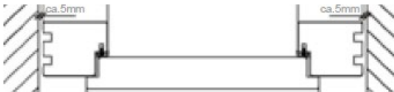
Ościeznica blokowa drewniana stała RSTA 75/66 ( EI 30 )
