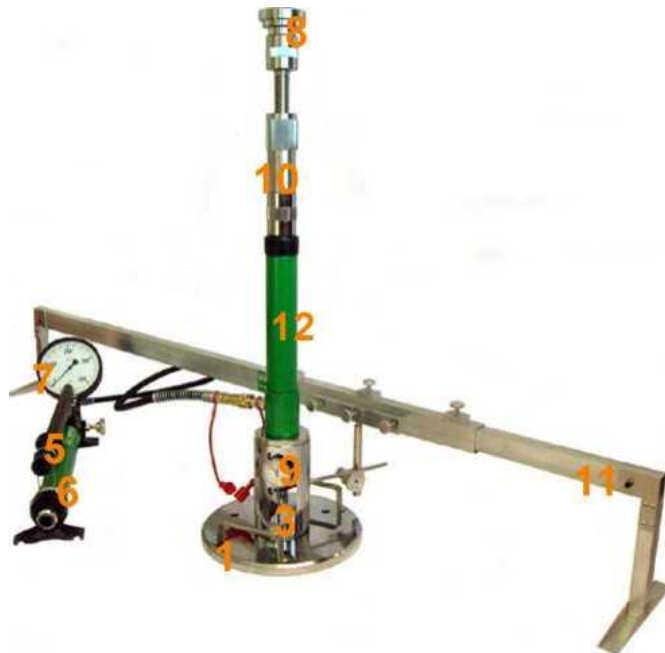
Rys. 1.2 Aparatura VSS z jednopunktowym pomiarem przemieszczenia płyty
