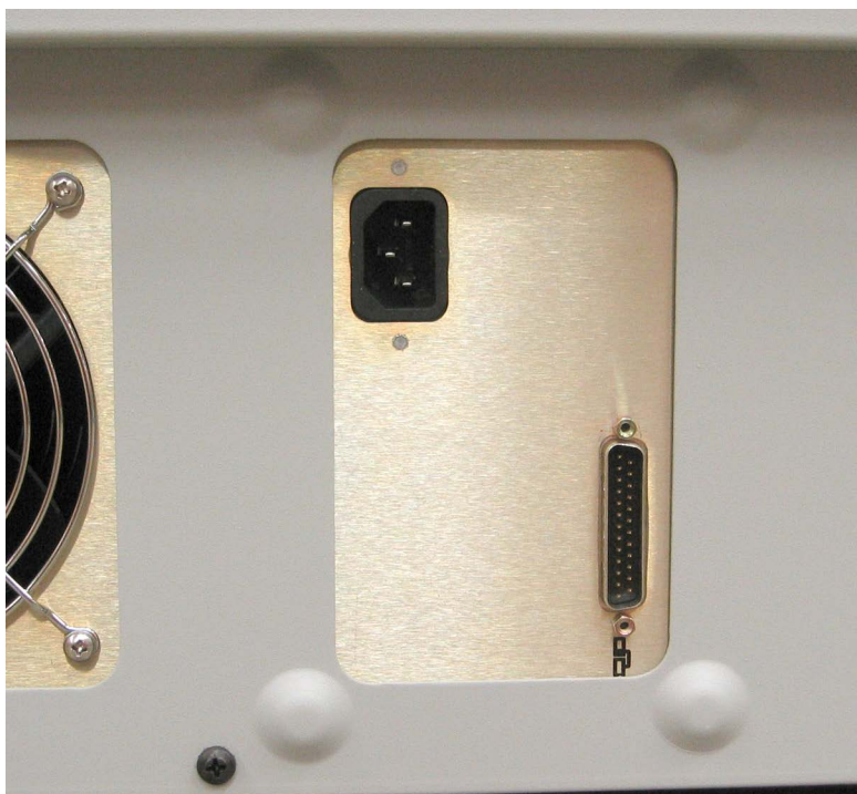
Rysunek 1-5 — Złącza na tylnej stronie aparatu dolnego BD BACTEC™ FX
