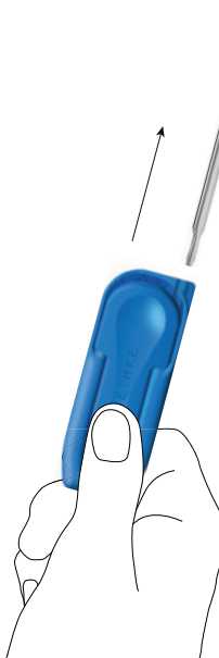
Krok 2 - Pnacisnąć dźwignię i wyjąć trzon
