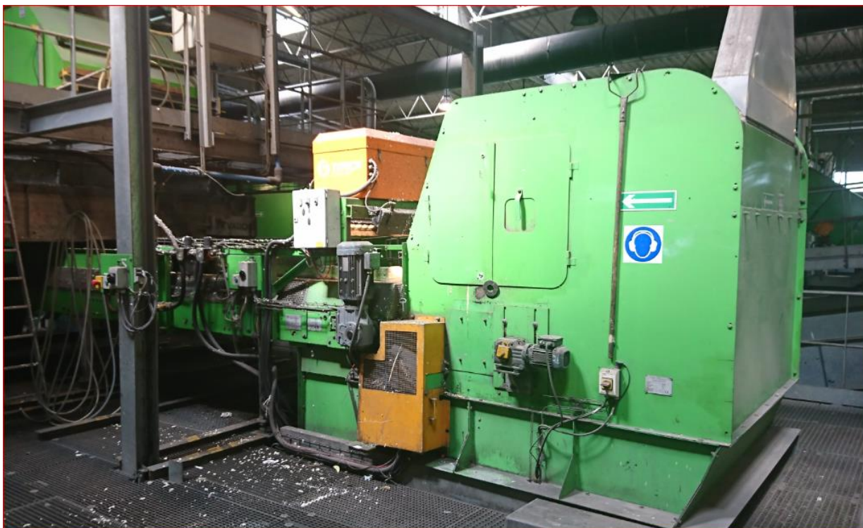
5. Rys. 5. Przykładowy separator opto-pneumatyczny.
