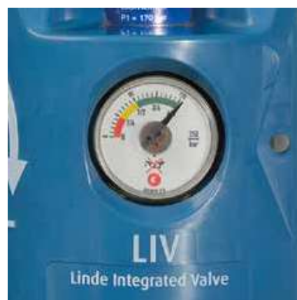
Manometr – wskazuje poziom napełnienia gazem
