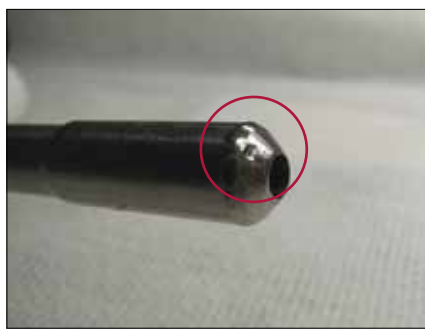
Tuleja przewodnika wiertła: wyszczerbienia na końcówce tulei
