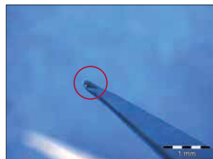
Uszkodzona końcówka nożyczek — funkcja tnąca może być ograniczona
