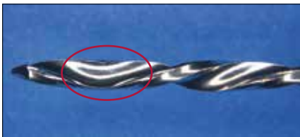
Wiertło: spirala — rowki tnące zmieniają kierunek
