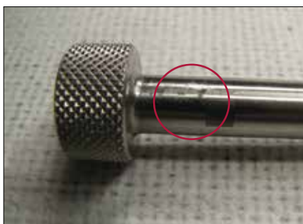
Tuleja chroniąca tkankę: powierzchnia uszkodzona przez część zespołu
