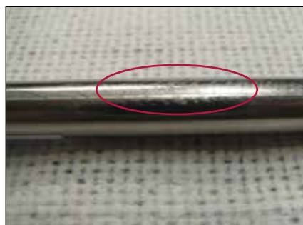
Tuleja chroniąca tkankę: powierzchnia uszkodzona przez część zespołu
