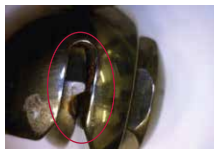
Korozja związana z naciskiem na dysk zaciskającym naciągacza drutu Tenxor
