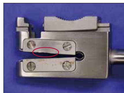
Uszkodzona końcówka tnąca — funkcja tnąca może być ograniczona
