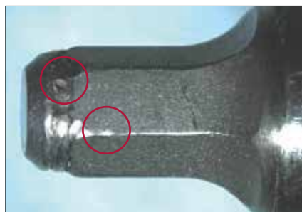
Złącze sześciokątne: zaokrąglone
