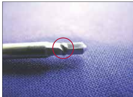
Złącze sześciokątne: zniekształcone
