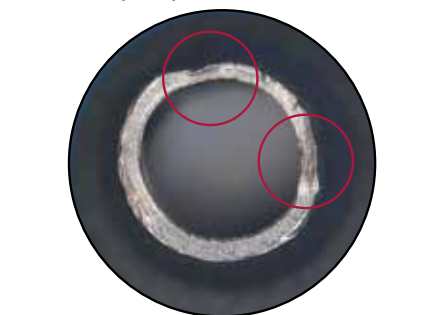
Prowadnik wiertła: wyszczerbienia na końcówce przewodnika wiertła
