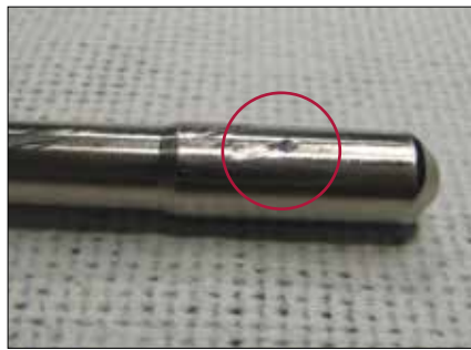
Tuleja przewodnika wiertła: rysy na powierzchni
