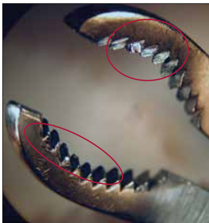
Zgięte zęby i uszkodzony mechanizm blokujący na szczypcach
