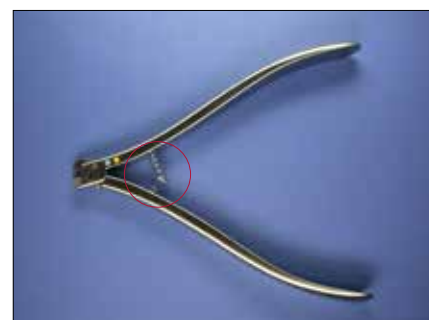
Uszkodzona sprężyna — funkcja przegubowa jest ograniczona
