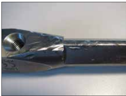
Ślady uderzeń na powierzchni funkcjonalnej
