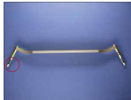
Ochraniacz tkanki miękkiej: wyszczerbienia na końcówkach ochroniacza tkanki miękkiej
