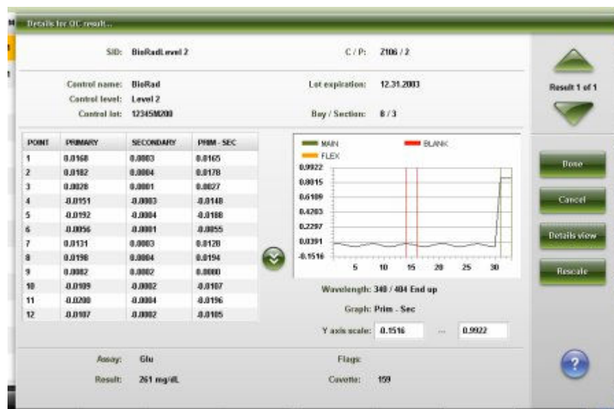
Ilustracja 5.84: Okno szczegółowych informacji o wyniku kontroli jakości (ekran przeglądania wyników kontroli jakości) - oznaczenie fotometryczne - widok z wykresem (c System)
