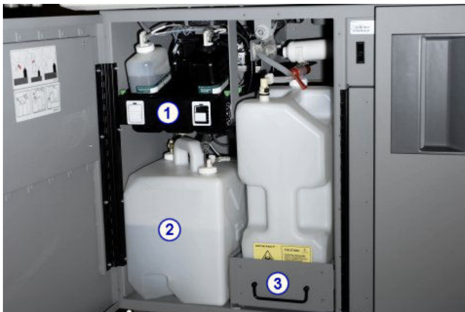
Ilustracja 1.161: Centrum roztworów roboczych i odpadów (i1000sR)
