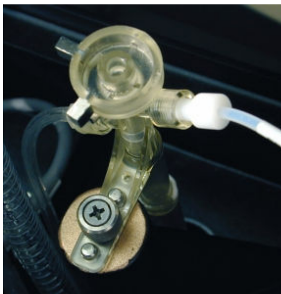
Ilustracja 1.115: Przykładowa stacja mycia sondy odczynnikowej (R1 lub R2 - i2000/i2000sR)
