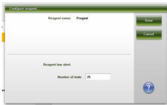
Ilustracja 2.59: Okno konfiguracji odczynnika na ekranie z ustawieniami odczynnika - widok oznaczenia Abbott (i System)
