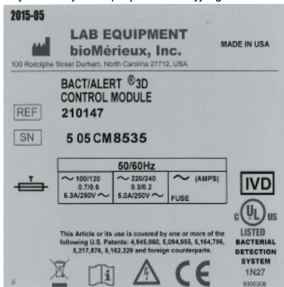
Rys. 2-3: Etykieta sprzętu laboratoryjnego — moduł sterujący (zastosowania kliniczne)
