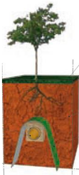
Ryc. 2 Poglądowa rycina przedstawiająca zastosowanie dennych ekranów przeciwkorzeniowych
