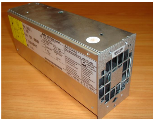
Rys.2 Widok zespołu prostownikowego /modułu/ typ E110-240G220/20BWru-PDT.
