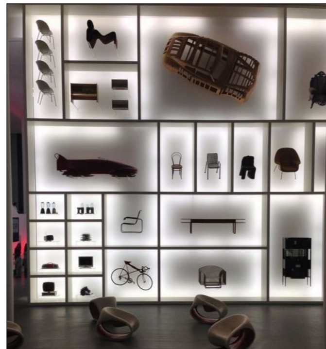
Zdjęcie referencyjne: gabłota z matowego i mlecznego plexi, kolor biały RAL 9003, podświetlenie typu backlight, po obwodzie
