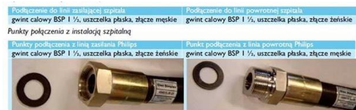
Rys. 5 Punkty połączenia z instalacją Philips
