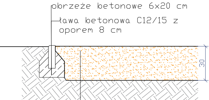
PRZEKRÓJ PRZEZ NAWIERZCHNIĘ PIASKOWĄ SKALA 1:20
