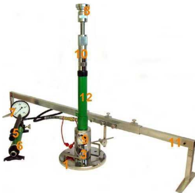
Rys. 1.2 Aparatura VSS z jednopunktowym pomiarem przemieszczenia płyty
