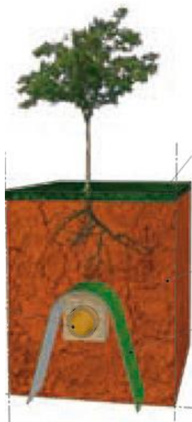
Ryc. 2 Poglądowa rycina przedstawiająca zastosowanie dennych ekranów przeciwkorzeniowych
